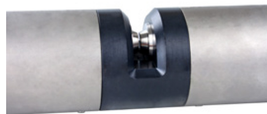
Abbildung 4: IQSN-UV-Sonden sind robust, genau und für den Einsatz unter Feldbedingungen ausgelegt. Die Optik wird mit der integrierten Ultraschallreinigung sauber gehalten und der 256-Wellenlängen-Scan des Sensors bietet unübertroffene Genauigkeit. Abgebildet ist ein Sensor mit 1 mm Abstand.
